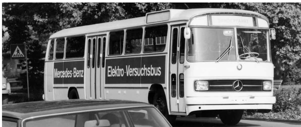
Fig. 11 – Primul autobuz de testare electrică - un exemplu timpuriu al tehnologiei hibride de acționare
